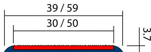
Le dispositif permettant le repérage visuel et la mise en sécurité des nez de marches par leur mise en contraste et leur traitement non-glissant sera un nez de marche plat à visser de 1150, 1500, 2305 ou 3005 mm de longueur, de 39 ou 59 mm de largeur et de 3,7 mm d'épaisseur de type PASSAGE by PROOPLE NP3AP (largeur 39 mm) ou NP5AP (largeur 59 mm) ou équivalent.
