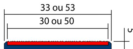
Le dispositif permettant le repérage visuel et la mise en sécurité des nez de marches par leur mise en contraste et leur traitement non-glissant sera un nez de marche insert à visser de 1150, 1500, 2305 ou 3005 mm de longueur et de 33 ou 53 mm de largeur de type PASSAGE by PROOPLE NI3AP (largeur 33 mm) ou NI5AP (largeur 53 mm) ou équivalent.
